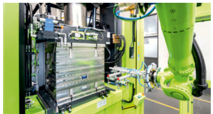
↑ Spritzgussanlage mit 6-Achs-Handlingroboter und Vorheizofen
