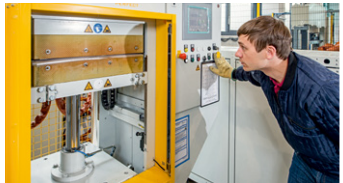
↑ Heißpresse zur Aushärtung von Prepreg-Bauteilen
