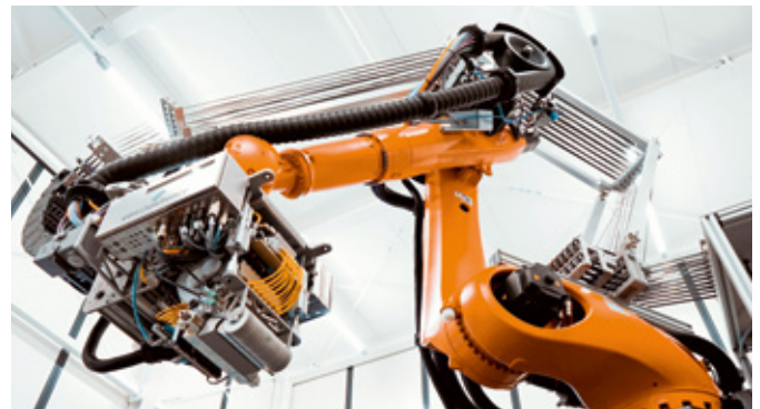
↑ Roboter-gestützte AFP-Anlage zur 3D-Ablage von Faserbändern
