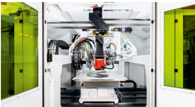
↑ Achsenbasierte 2D-AFP-Anlage zur Verarbeitung von TowPreg
