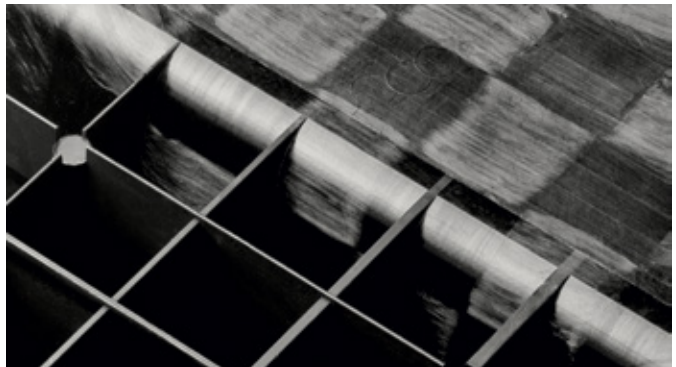
↑ Umgeformtes Gewebe-Organoblech mit angespritzten Rippen
